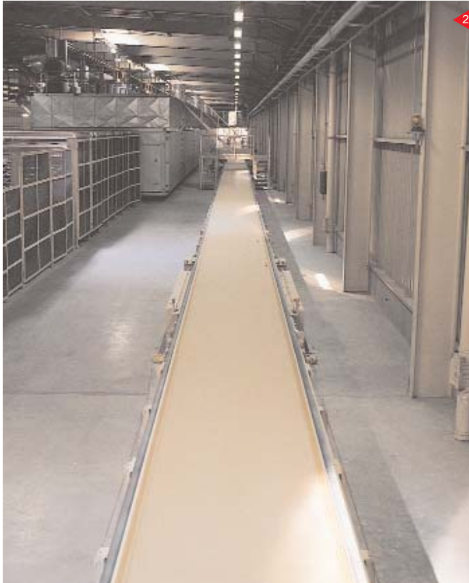
دوغاب موجود در صفحات ریکشدار همزمان با حرکت بر روی تسمه نقاله به تدریج سخت می شود.
