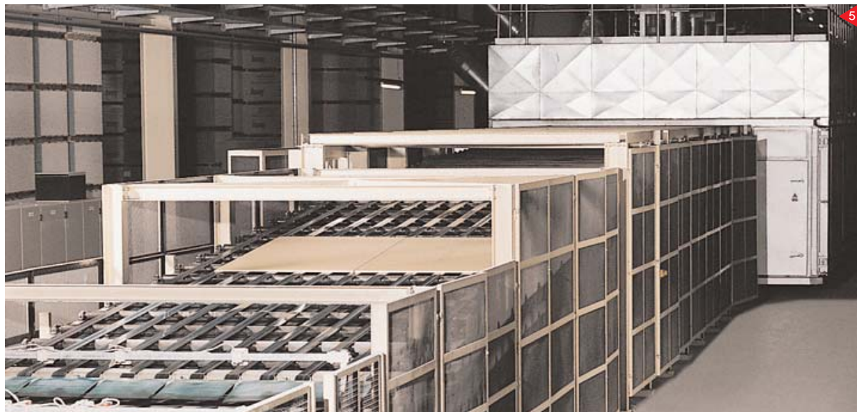
رطوبت موجود در صفحات بعد از ورود به قسمت خشک کن بوسیله یک جریان هوای گرم بتدریج از آن خارج می شود.
