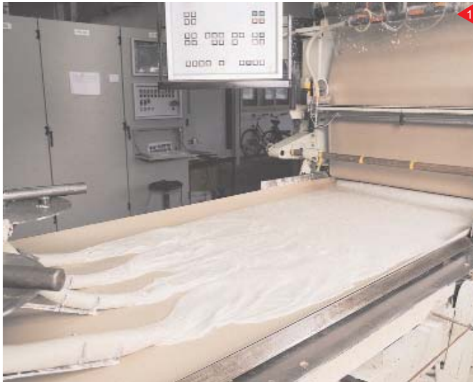
دوغاب گچ بوسیله چند خروجی بصورت یکنواخت بر روی کاغذ مخصوص پخش می شود.
