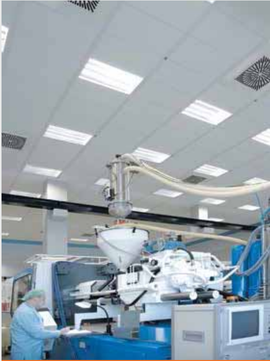
سقف کاذب ویژه اتاق تمیز (Clean room)
