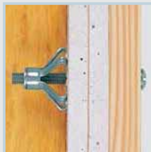
مهار جمع شونده فلزی (دیوار دو لایه)
